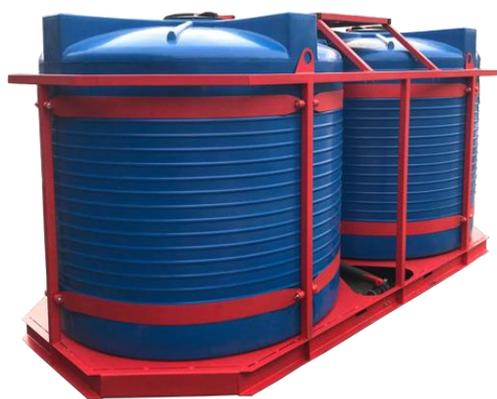
Новая модель транспортировочной кассеты для установки двух вертикальных бочек на 5000 литров. Конструкция имеет металлический настил и места крепления насосов, шлангов и запорной фурнитуры, а так же лестницу и съемную площадку для легкого доступа к заливной горловине – готовое решения для создания растворных узлов и специализированной сельскохозяйственной и коммунальной техники.
